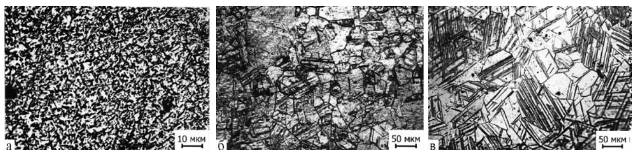
Рисунок 44 – Микроструктура стали 12X18H10T-2 в состоянии поставки (а) и после отжига в течение 30 (б) и 120 (в) минут (Оптическая металлография)
