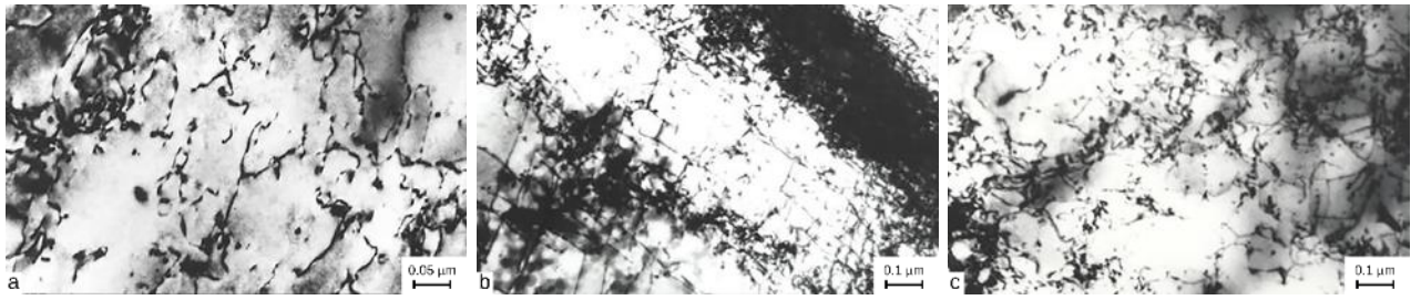
Рисунок 40 – Микроструктура необлученного железа, деформированного при температурах: а – 100°C; б – 200°C; с – 300°C
